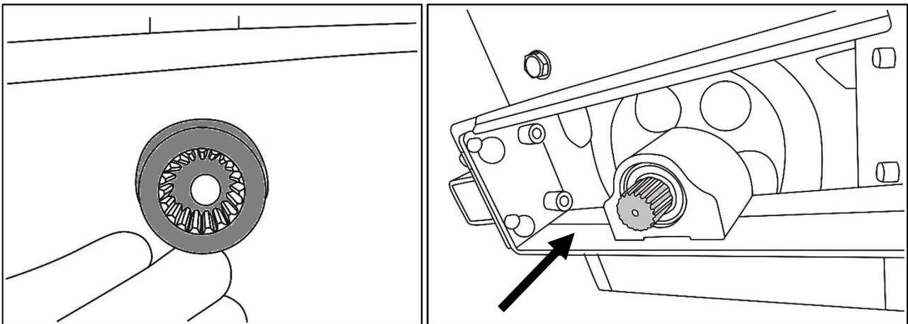
Рис. 5. Соединение шлицов модуля и подметальной машины
