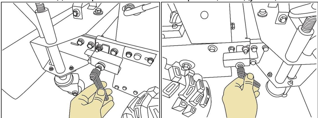
Рис. 6. Закручивание болтов фиксации
